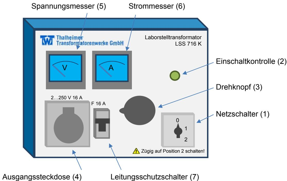
Das Gerät wird über einen festen Anschluss an ein ordnungsgemäß installiertes Netz mit einer Nennspannung von 230V PN versorgt.
